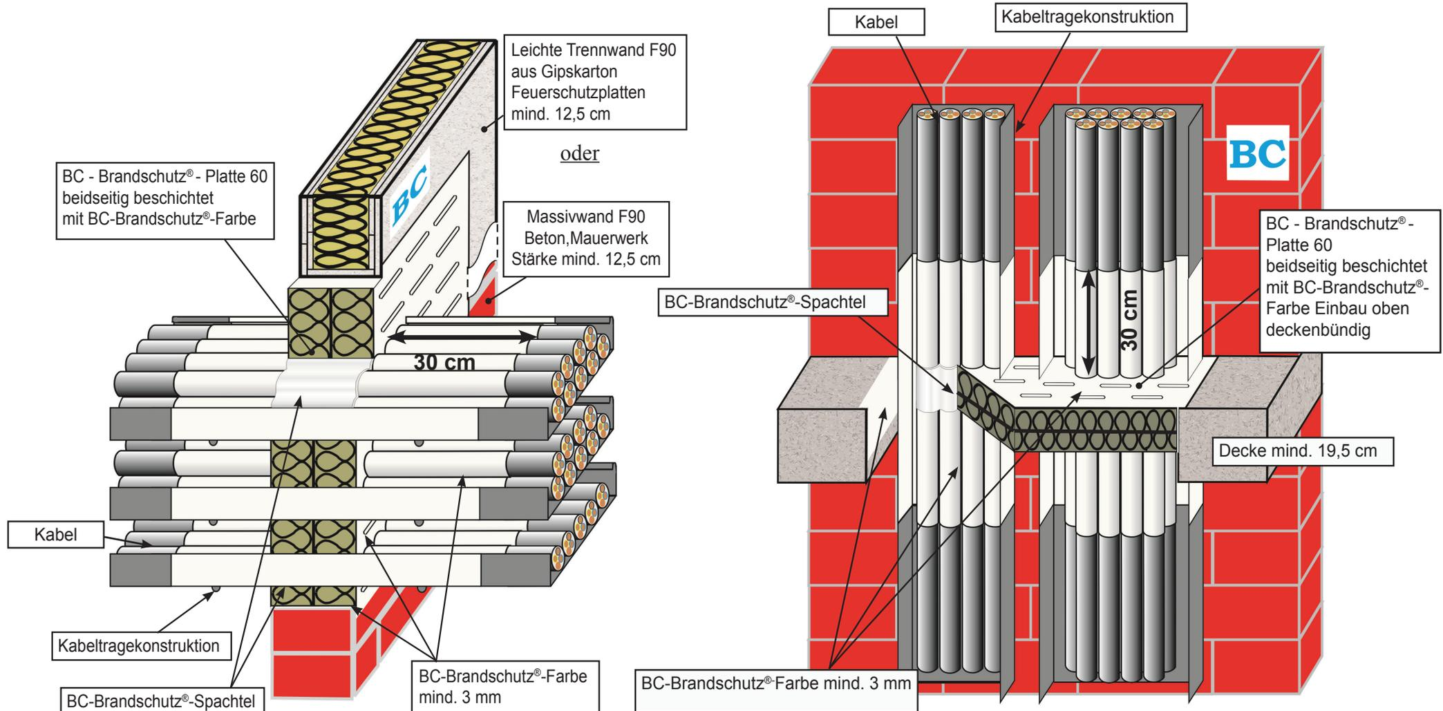
Maximale Öffnungsgröße bei Wandabschottungen: Massivwand 1000 mm x 2000 mm
